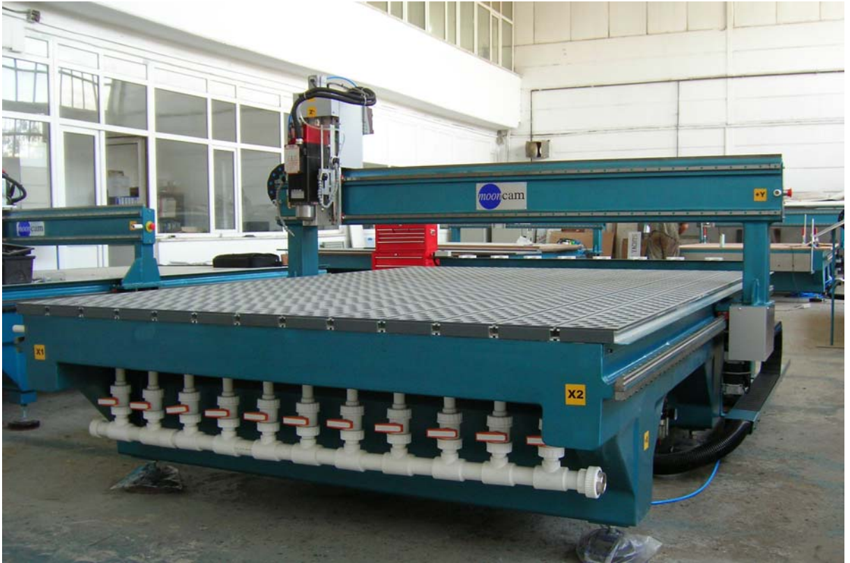
CNC nin vakuma hazır tabla olarak genel görünüşü.
