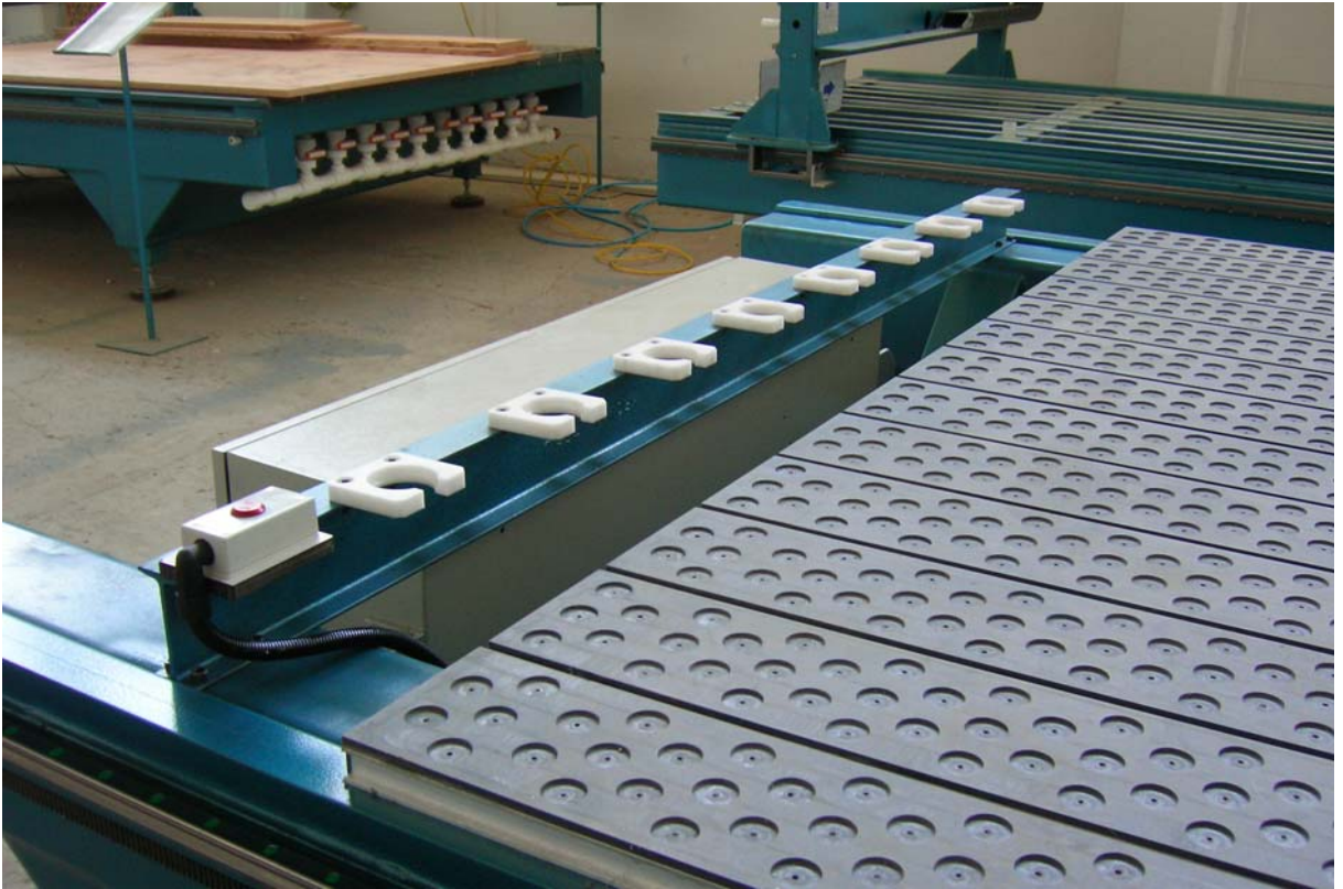
Sabit pozisyonda otomatik takım deęiřtirme magazini.
