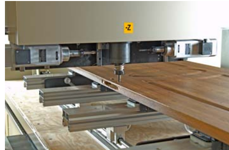
9 kw 24.000 rpm ana freze motoru
