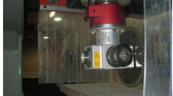
Kilit-menteşe ve alt üst kanak kesimi için testere Montajlanan agregate ünitesi
