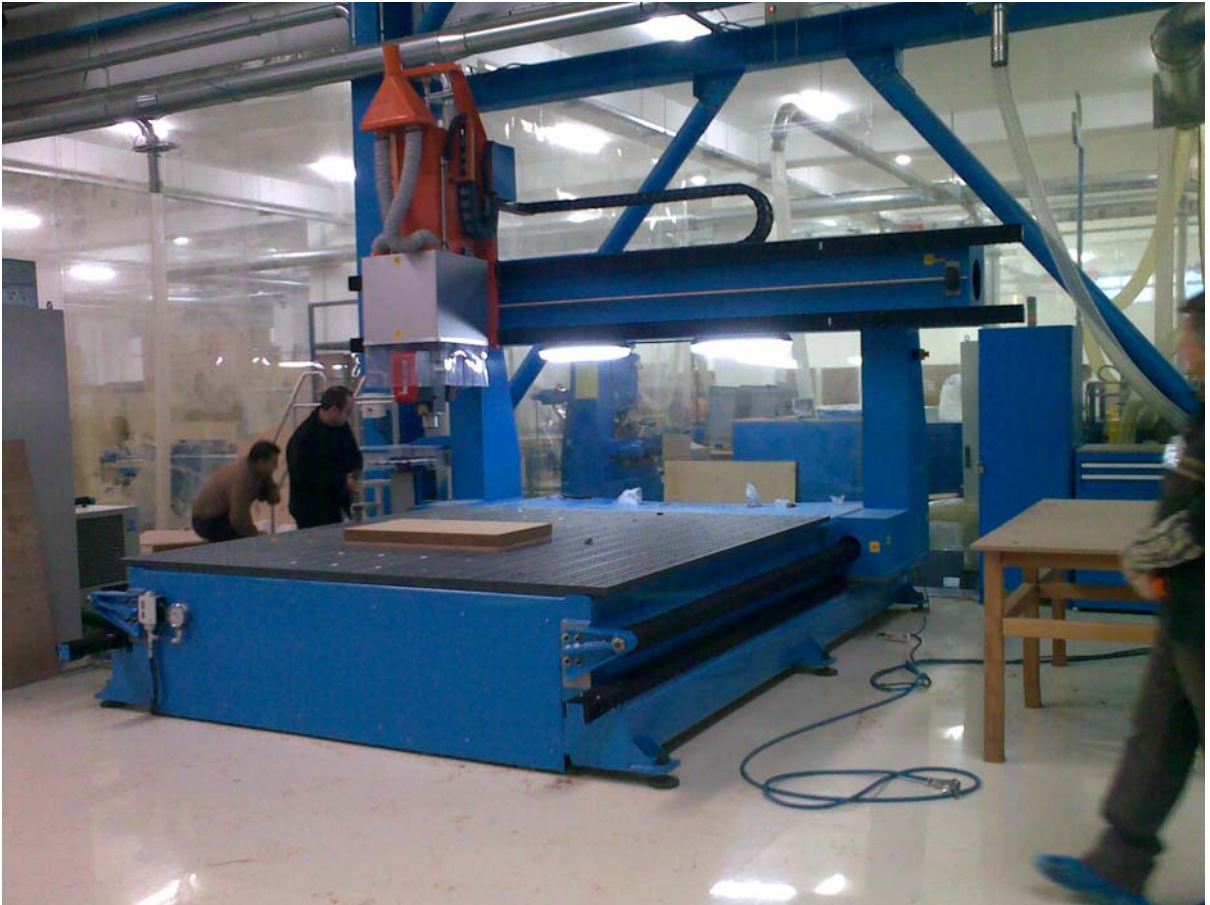
Mil ve kızak koruma körükleri ile toz toplama sistemi.
